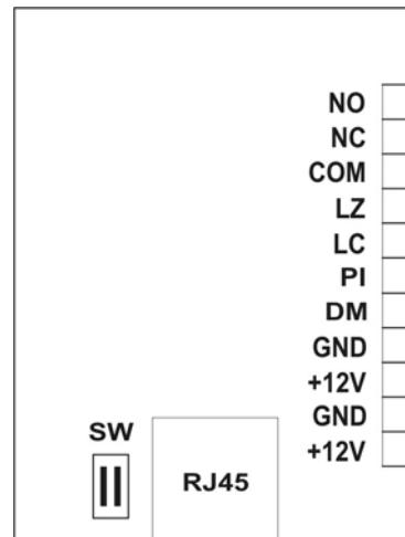
**Pozor: Svorky elektromagnetického zámku musí být vybaveny antiparalelní diodou min. 0,5A.**
